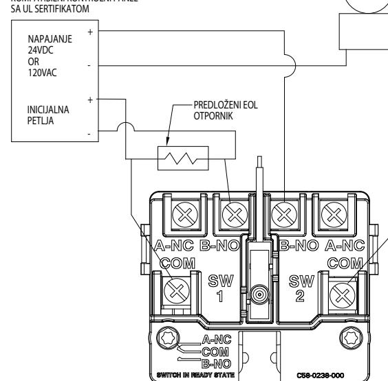
NAPOMENA: ZAJEDNIČKI 1-B-NO PRIKLJUČIĆE SE ZATVORITI KADA JE LOPATICA ZAKRENUTA, T.J. KADA VODA TEĆE. DVOSTRUKI PREKIDAČI DOZVOLjavaju KOMBINOVANU PRIMENU NA JEDNOM DETKToru.
