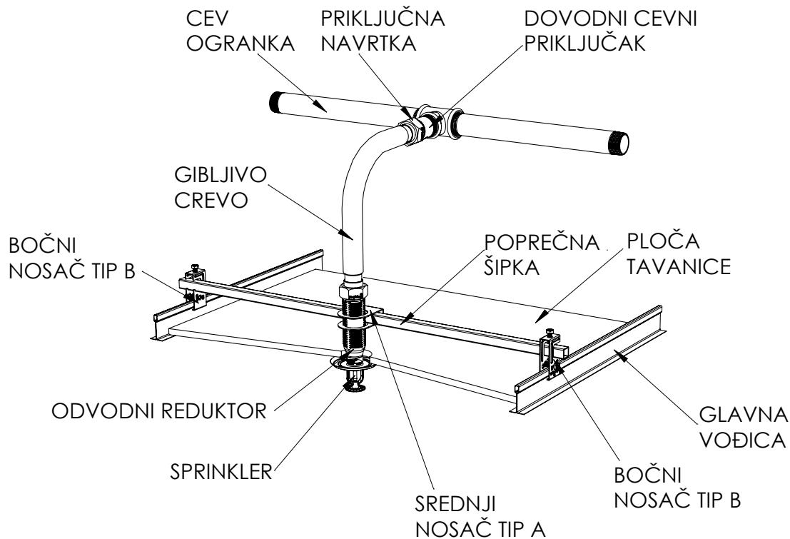
1. Ugradite dovodni cevni priključak u odvod cevi ogranka, koristeći uobičajene metode zaptivanja i pritezanja za navoje priključne cevi. Čvrsto pritegnite ključem za cev, da ne bi curilo na priključku. Za SPW ovaj dovodni cevni priključak je trajno pričvršćen na gibljivo crevo i mora da se vodi računa da se crevo ne uvrne ili da se koristi kao poluga kada se priteže u cevni priključak.
